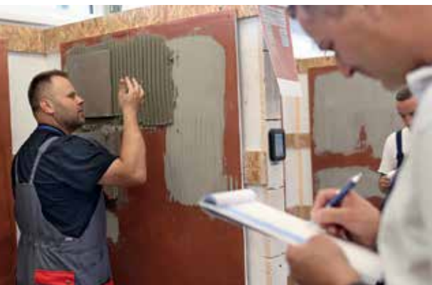
Test kciuka. Im dłużej klej wiąże, tym lepiej dla wykonawcy – ma więcej czasu na skorygowanie przyklejonej płytki.
