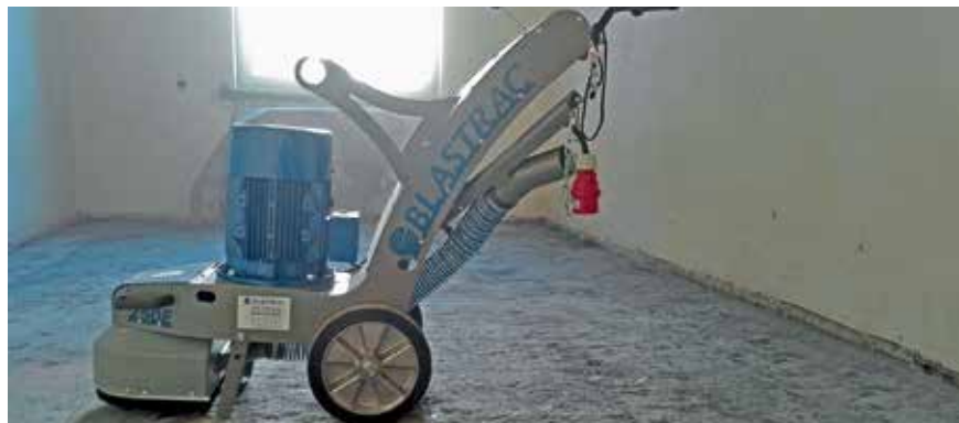
Szlifierka jednotarczowa do usuwania subitu. To wydajne urządzenie sprawdza się również na dużych powierzchniach.
