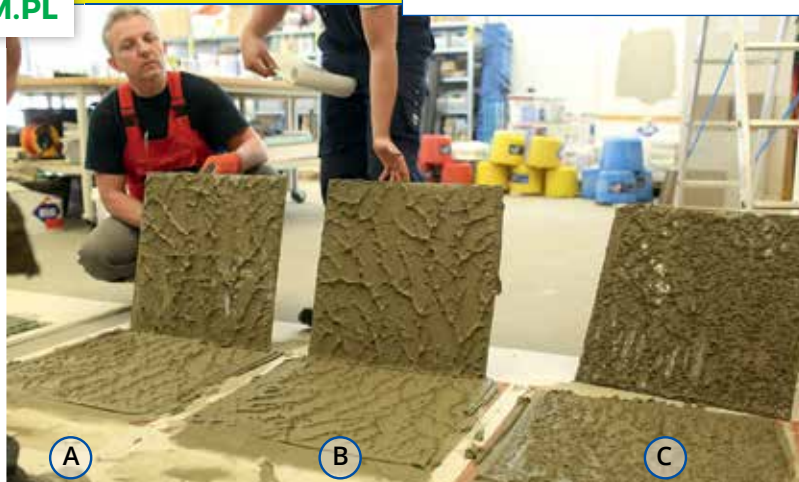
Próbka A, B, C. Ocena rozplywności klejów po oderwaniu od szyby. Próbka B – prawie 100% wypełnienia kleju pod szybą.
